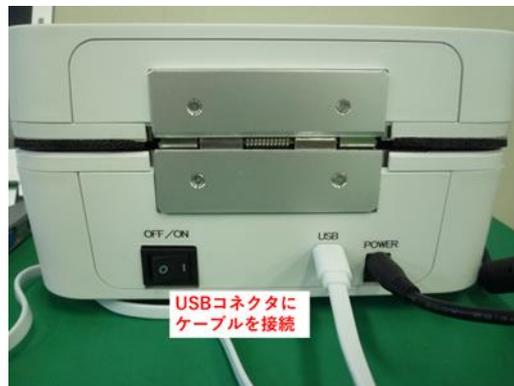
PC と PAKA クリーンの電源を入れ、PAKA クリーンの本体背面にある USB コネクタと PC の USB コネクタを microUSB ケーブルで接続します。
