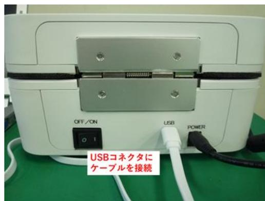
PC と PAKA クリーンの電源を入れ、PAKA クリーンの本体背面にある USB コネクタと PC の USB コネクタを microUSB ケーブルで接続します。
